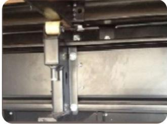
Soporte y rodamiento ajustable entre cada viga principal que permite un desplazamiento mas suave además de asegurar la posición correcta de la grada.
